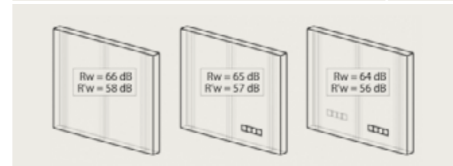
Schéma akustického opláštění elektrokrabic např. v příčce W115
